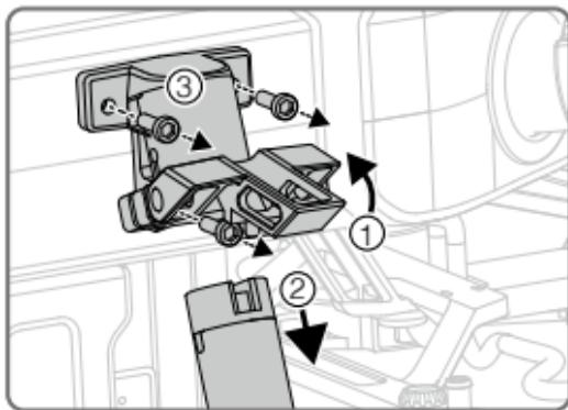
3. 安装外置 GPS 套件，安装完毕后确认旋钮处于锁紧状态（如图示）。重新安装右侧起落架。
