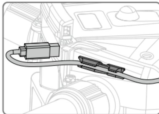
5. 连接外置 GPS 套件至飞行器接口。
